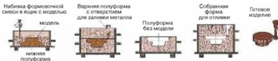
Рис. 5.3. Изготовление формы для отливки изделия
