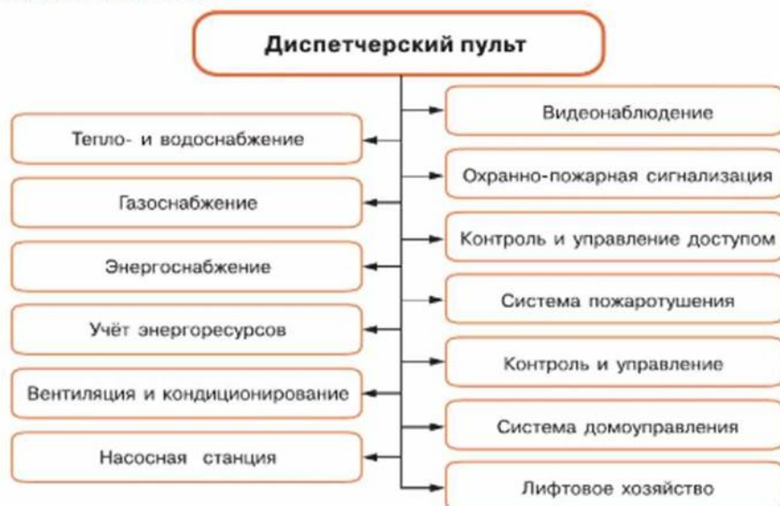
Рис. 4.4. Компьютеризованная система управления крупным коммунально-хозяйственным комплексом
