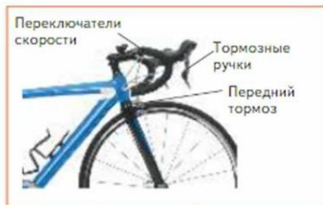
Рис. 4.1. Органы управления самокатом (а) и велосипедом (б)
