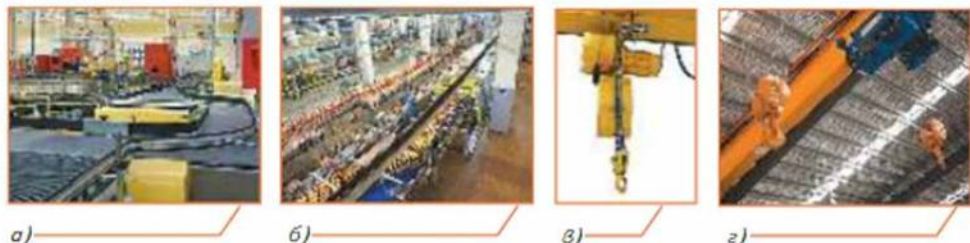
Рис. 13.7. Внутрипроизводственные фиксированные транспортные средства: а, б — конвейеры; в — электрическая таль (тельфер); г — мостовой кран
