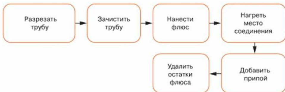
Рис. 5.5. Последовательность пайки
