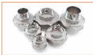
Рис. 2.3. Образцы калибров, применяемых для контроля размеров деталей
