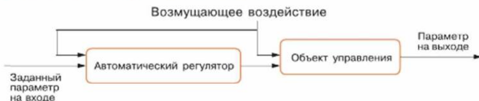
Рис. 4.5. Принцип управления по возмущению
