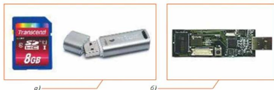
Рис. 8.5. Флеш-память: а — виды карт памяти и USB-флеш-накопителей; б — устройство USB-флеш-накопителя
